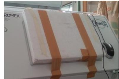
6. Man stecke Pappstücke oder anderes Verpackungsmaterial zwischen Rutsche und Schwingrinne, sowie zwischen Schwingrinne und den inneren Beladetrichter, um das Bewegen des Vibrators und damit die Beschädigung der Rutsche während des Transports zu verhindern.
