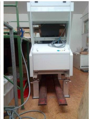
8. Der Farbsortierer wird mit einem Gabelstapler angehoben. Bitte stellen Sie sicher, dass die Gabeln lang genug sind, um den Rahmen komplett aufzunehmen.
