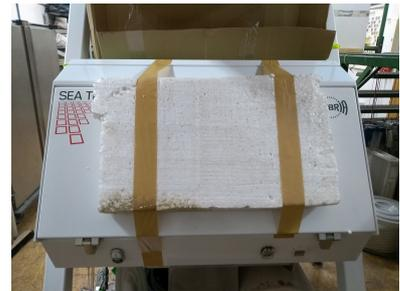
6. Man stecke Pappstücke oder anderes Verpackungsmaterial zwischen die Schwingrinne über dem Vibrator und die Rutsche sowie zwischen Schwingrinne und Beladetrichter, um das Schwingen während des Transports zu verhindern.
