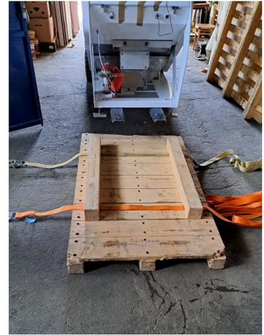
9. Anschließend werden die Füße so ausgedreht, dass sie mit leichter Kraft auf der Palette stehen.
