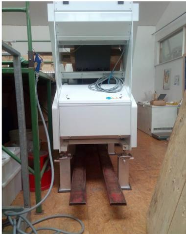
8. Der Farbsortierer wird per Gabelstapler auf die mitgelieferte Palette gehoben, die Füße bleiben vorerst unbelastet. Dann wird die Maschine mit zwei Spanngurten auf der Palette fixiert.
