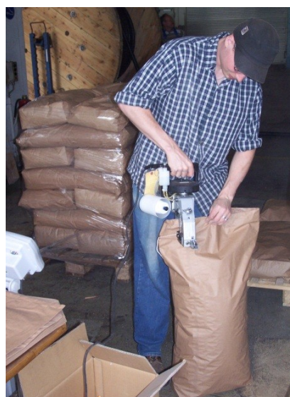
Beladen des Farbsortierers Futura und anschließendes Vernähen der Säcke.
